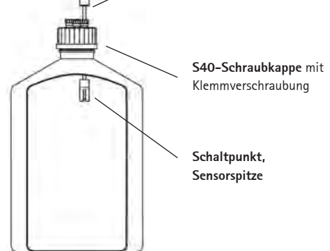
Füllstandssensor zur Lösungsmitteldisposition (Bestell-Nr. 9.67100.2002)
