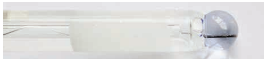
3 Blaue pH-Glaskugel an der Spitze einer pH-Elektrode.
