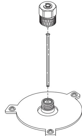
Installation des Glasliners für Purged-Packed-Säuleneinlässe (PPI)
