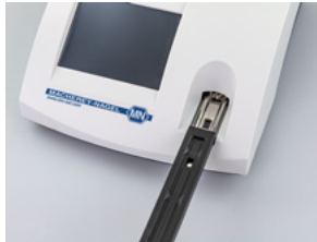
Abb. 17: Wiedereinsetzen des Teststreifenhalters
