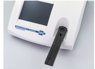
Abb. 18: Ausrichtung der Kerben prüfen
