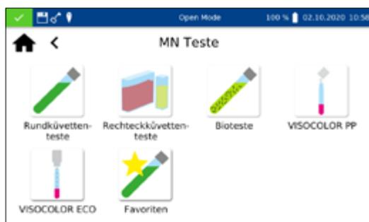
Das Methodenauswahlfenster erreicht man durch Drücken von
