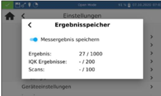
Durch Anklicken des Eintrags *Speicher* können Sie die Speichereinstellungen einsehen. Neben einer Übersicht über die Speicherauslastung kann hier der Messergebnisspeicher ein- bzw. ausgeschaltet werden. Durch Setzen des Schiebereglers wird der Speicher entsprechend aktiviert oder deaktiviert.
