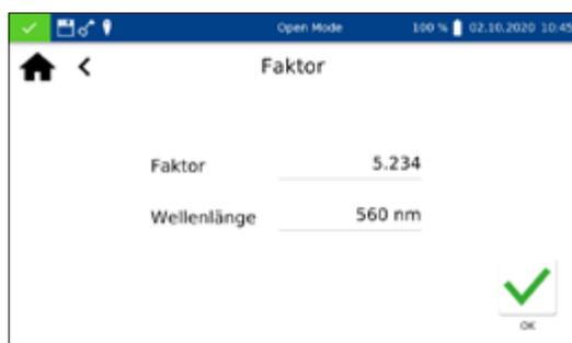
Die Basisfunktion Faktor bietet die Möglichkeit der Bestimmung eines Messergebnisses durch Multiplikation der Extinktion mit einem definierten Faktor.
