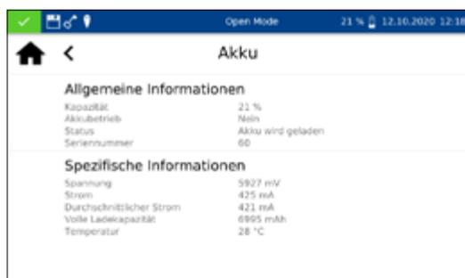
Beim Anklicken des Icons „Akku“ öffnet sich ein Fenster mit Informationen zum internen Lithiumionenakku des Gerätes. Hier werden unter anderem Informationen zu Kapazität, Status und Spannung angezeigt. Bitte halten Sie diese Informationen bei Kontakt des technischen Supports von MACHEREY-NAGEL bereit.
