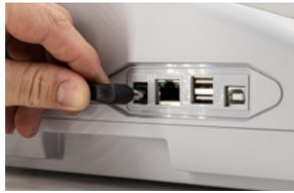
Abb. 2: Anschließen der Spannungsversorgung
