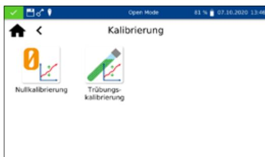
Die Spektralphotometer führen bei jedem Start einen Selbsttest zur Überprüfung der Basiskalibrierung durch. Die Basiskalibrierung oder Nullkalibrierung sowie die Kalibrierung der nephelometrischen Trübungsmessung können bei Bedarf manuell über das Kalibrierungsmenü durchgeführt werden.
