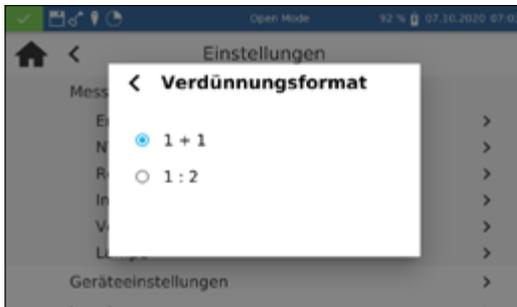
Durch Anklicken des Eintrages Verdünnungsformat wird ein Fenster zum Setzen des Verdünnungsformates aufgerufen. Die Formate „1 + X“ und „1 : X“ sind auswählbar. Bei Aktivierung wird die gewählte Verdünnung in diesem Format angezeigt und in allen Menüs mit Eingabe einer Verdünnung berücksichtigt.
